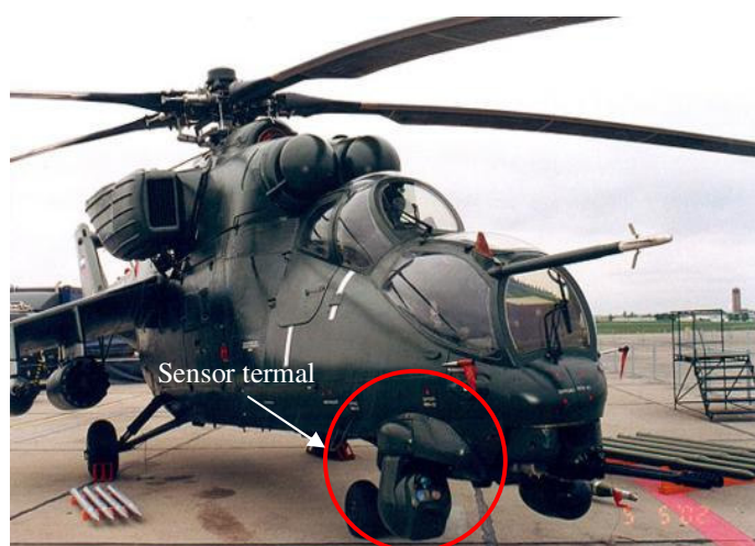
Fig.1. Sensor termal instalado em um Mi-35M2 Hind
